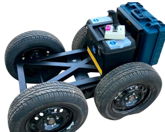
ROBOT AGRÍCOLA MULTIPROPÓSITO Primera aplicación: fumigación de viveros.
